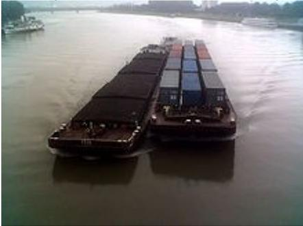
[Schubverband](#) bestehend aus kleinem Schubschiff hinten, einem Containerschubleichter (auf dem Bild rechts) und einem Massengutschubleichter (links) auf der Donau in Linz
